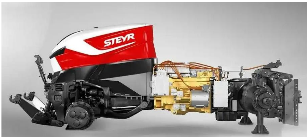
Новая гибридная электрическая трансмиссия для трактора Steyr Konzept (media.cnh.com)
